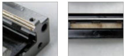
上部給油パッドは正常に設置、正常に給油、レール溝も正常
